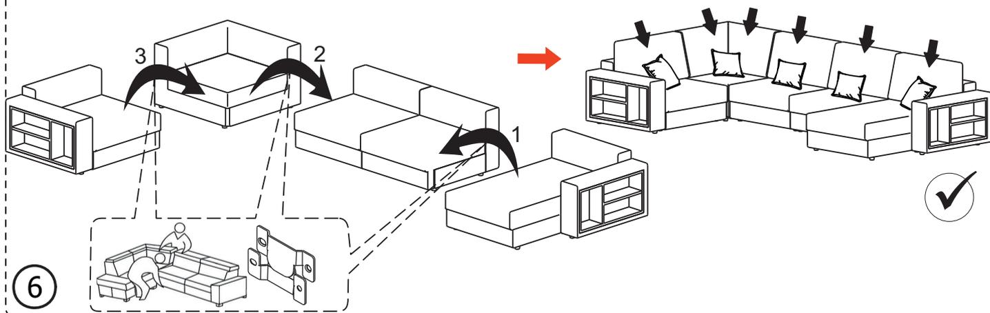
Для изменения взаимного расположения секций П-образного дивана относительно друг друга, необходимо снять боковины, расстыковать секции и переустановить соответствующие зацепы с оснований секций на противоположные стороны. Затем установить боковины и состыковать секции.
